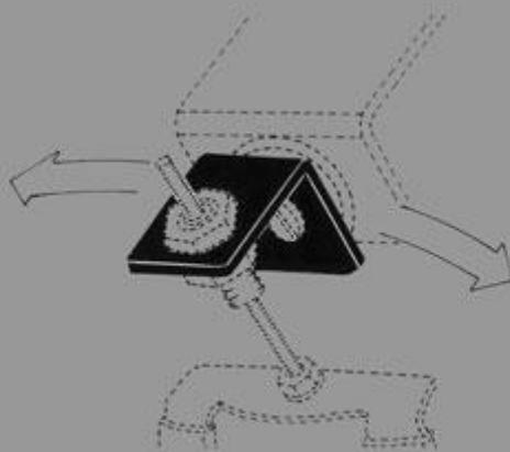
Die **Winkelstücke** bestimmen die Stellung des Geigenhalses (hoch, tief). Durch gleichzeitiges Drehen beider Winkelstücke wird die Stütze zum Geigenkorpus schräggestellt und nimmt das Instrument aus der waagerechten Haltung.
