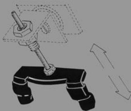
Die **Halteklaue**n garantieren festen und beschädigungsfreien Sitz am Instrument ohne Klangverlust. Durch Hinein- bzw. Herausdrehen der Gewinde wird der Abstand zwischen Geigenboden und Schulter derart bestimmt, daß eine unverkrampfte und gerade Kopfhaltung der Musikerin, des Musikers möglich wird.
