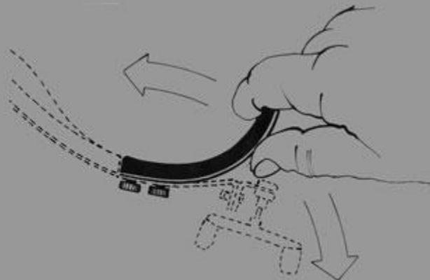
Das **Hakenteil** hält die Schulterstütze an der Schulter rutschsicher fest. Es kann aufgrund seiner Flexibilität mit der Hand gebogen werden, so daß es sich jeder Schulterform anpassen lässt:
