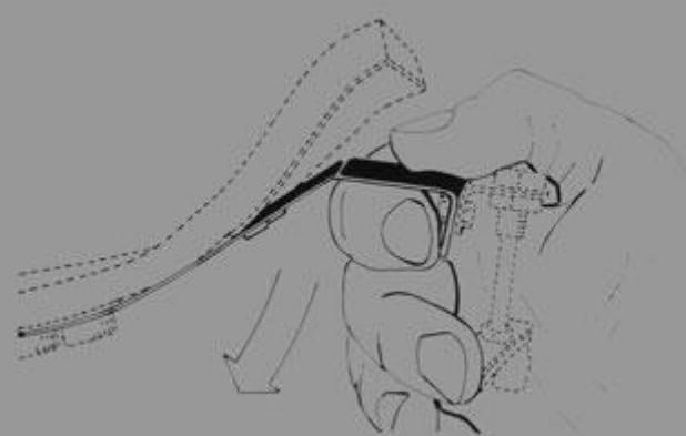
Der **Haltekraftwinkel** ermöglicht ein leichtes Abnehmen der Schulterstütze vom Instrument sowie einen festen Sitz. Handgefertigte Instrumente unterliegen einer geringen Größenschwankung; diese kann durch Verkleinern oder Vergrößern des Winkels ausgeglichen werden:
